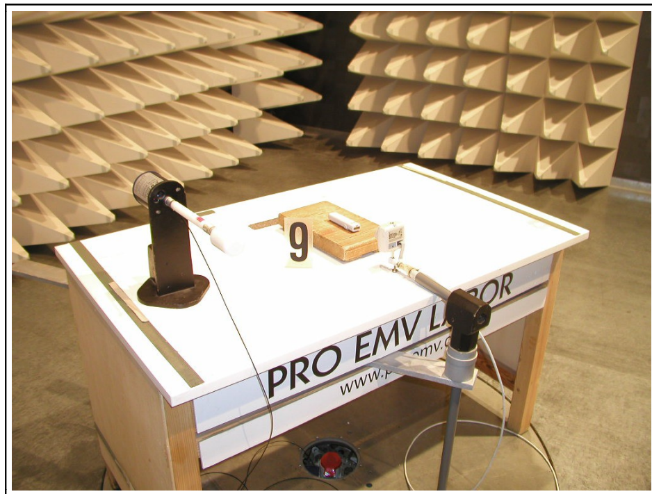
Bild 1 : Prüfanordnung "Funkstörfeldstärkemessung", "Störfestigkeit gegen elektromagnetische Felder"
