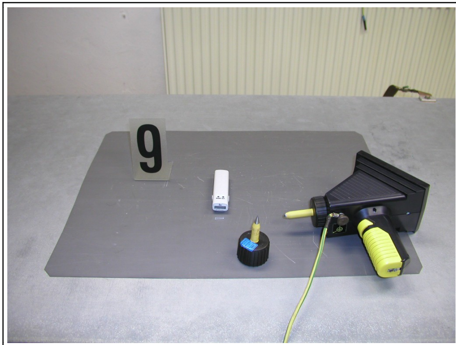
Bild 3: Prüfanordnung "Störfestigkeit gegen elektrostatische Entladungen (ESD)"
